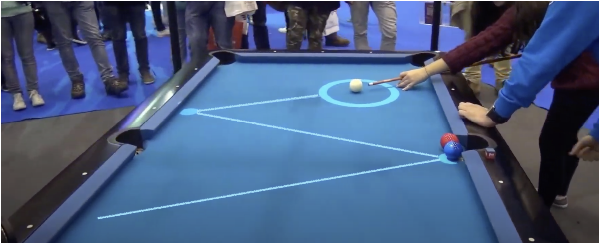
FIGURE 2 – L'application reconnaît la bille et l'angle de la queue, puis calcule la trajectoire de la bille et la projette sous forme de lumière sur la table.
