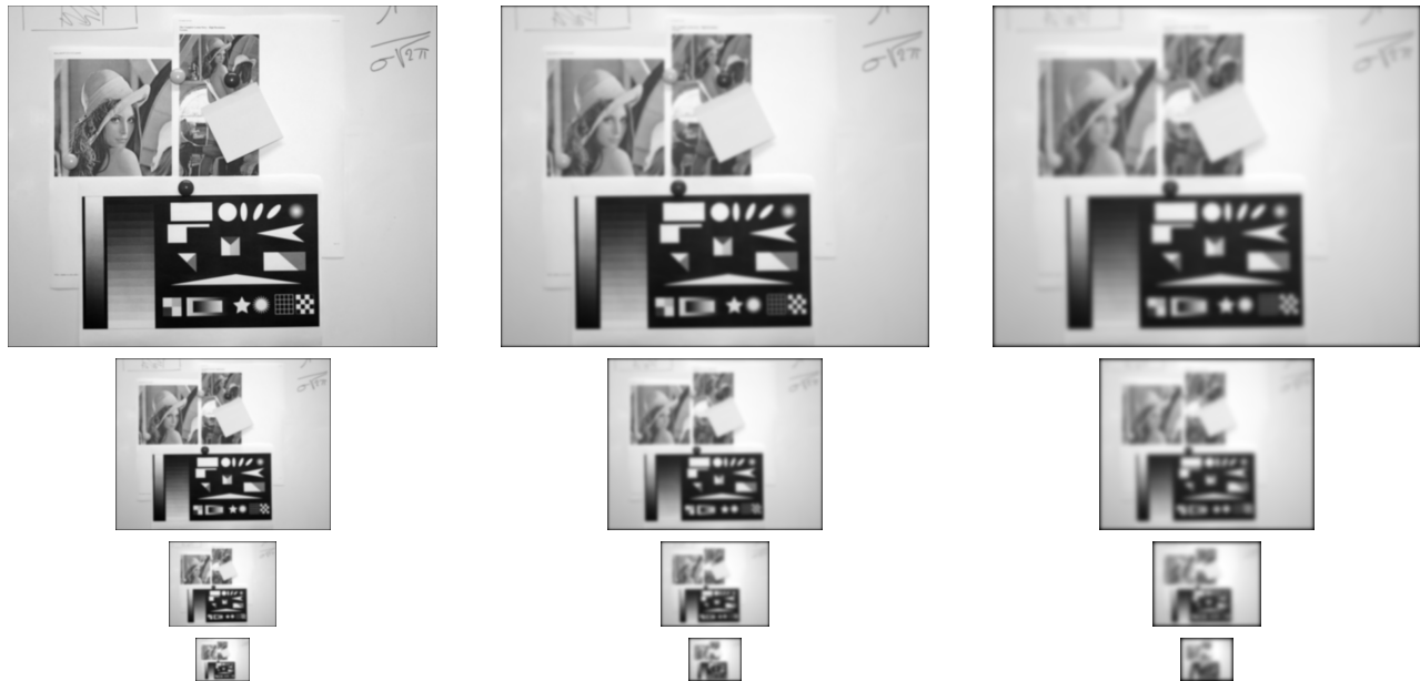
FIGURE 3.5 – Illustration de l'introduction d'une analyse multi-échelle dans une pyramide d'images (multi-résolution) – Ces illustrations sont extraites de la thèse de Guillaume GALÈS [Gales 11]. De haut en bas, la résolution des images est diminuée, formant ainsi une pyramide d'images. De gauche à droite un filtrage gaussien est appliqué avec un filtre de plus en plus grand, pour fournir une analyse multi-échelle.
